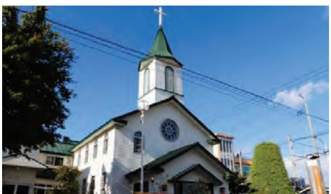
戦前に日本に16年滞在し、学校や宗教施設などの多くの建築設計を行ったスイス人のマックス・ヒンデルが設計した木造教会であり、正面の切妻屋根に鐘楼を戴き、切妻の玄関を張出し、外壁下見板張にアーチ窓を配する。内部は三廊式で側廊上部を回廊とし、身廊両側に円柱を並べて柱頭飾を載せ、連続アーチを架ける。西洋のロマネ
